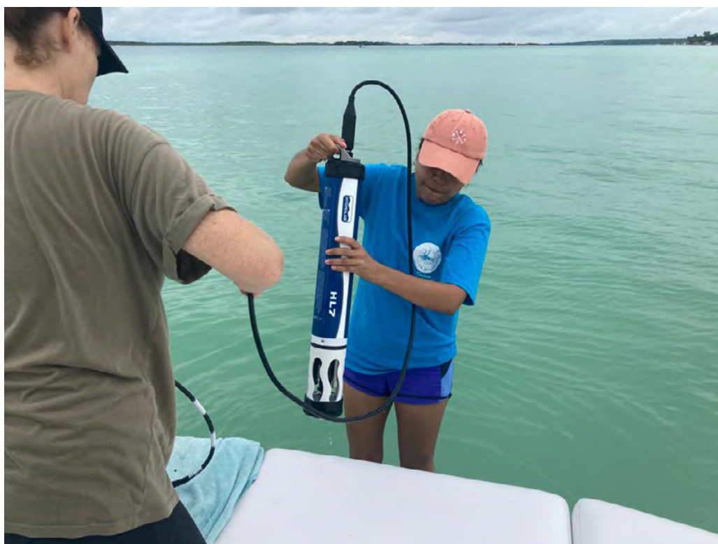
Foto 1. Monitoreo con sonda multiparamétrica Hydrolab HL7 (Lise Lingo, 2021)
